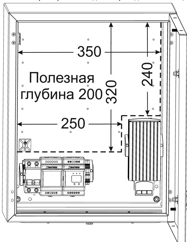
Рисунок 1 – Пространство внутри для установки доп. оборудования
