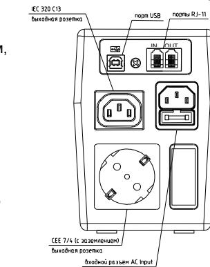
Рисунок 1 - Задняя панель ИБП
