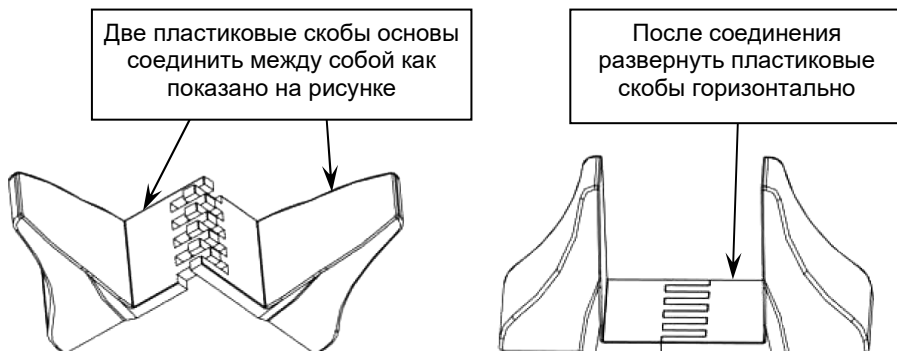
Рисунок 3 - Сборка пластиковых основ для вертикальной установки изделия.
