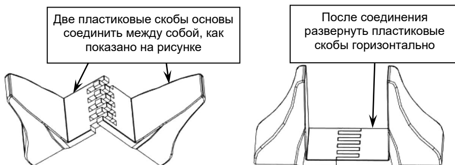
Рисунок 4 - Сборка пластиковых основ для вертикальной установки изделия.
