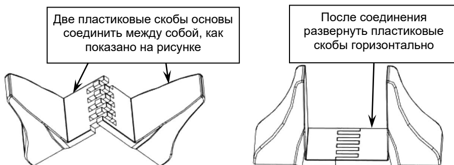
Рисунок 4 - Сборка пластиковых основ для вертикальной установки изделия.
