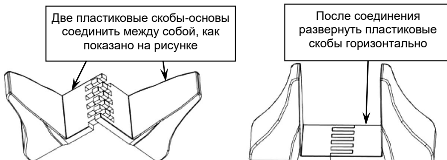
Рисунок 4 — Сборка пластиковых основ для вертикальной установки изделия.
