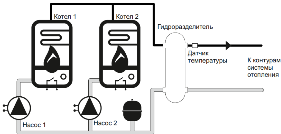
Рисунок 1 – Функциональная схема системы отопления
