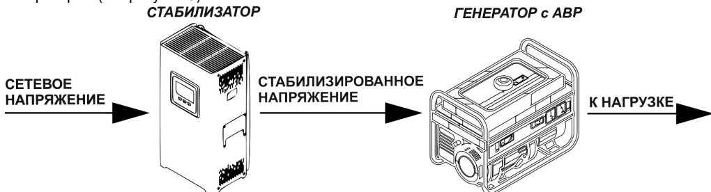
Рисунок 9 - Конфигурация 2 (размещение стабилизатора перед генератором)
