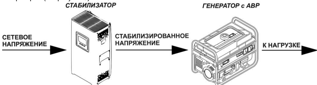
Рисунок 9 - Конфигурация 2 (размещение стабилизатора перед генератором)
