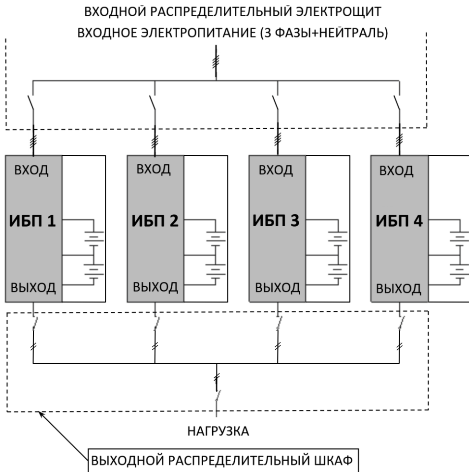
Рисунок 20 — Пример схемы подключения четырех изделий в систему параллельного резервирования с выходным распределительным шкафом.
