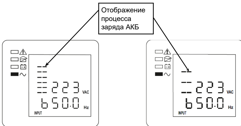
Рисунок 17 — ЖК-дисплей, форсированный (ускоренный) заряд АКБ
