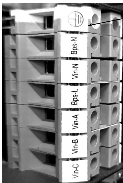
Рисунок 19 — Входной клеммный блок изделия
