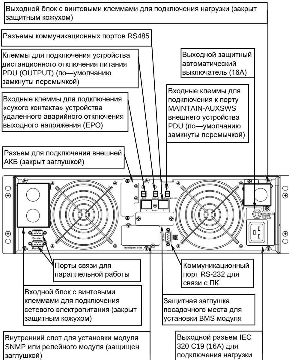
Рисунок 2 — Общий вид задней панели изделия
