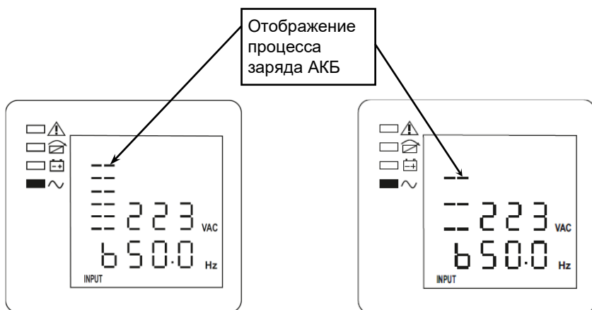
Рисунок 16 — ЖК-дисплей, форсированный (ускоренный) заряд АКБ
