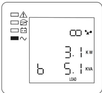
Рисунок 15 — ЖК-дисплей: фаза В, мощность нагрузки
