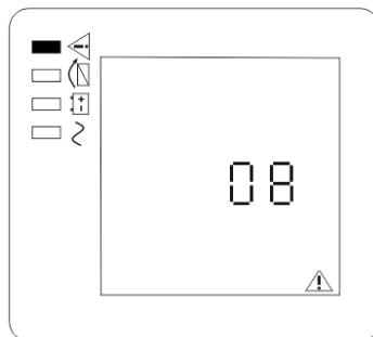
Рисунок 26 – Пример отображения кода неисправности на ЖК-дисплее
