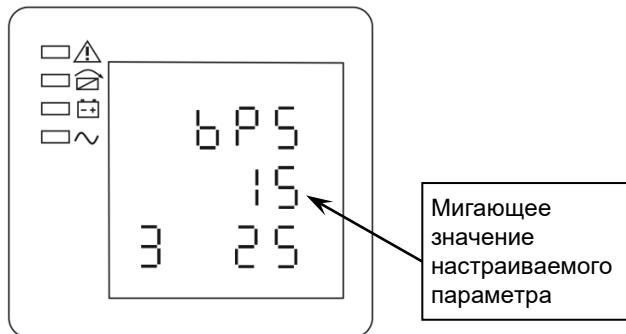
Последовательными нажатиями на кнопку  $\curvearrowleft$  (метод перебора) осуществляется выбор одного из четырех вариантов значения верхней границы: «10 %», «15 %», «20 %» или «25 %» (25 % — только для выходного напряжения 220В).
