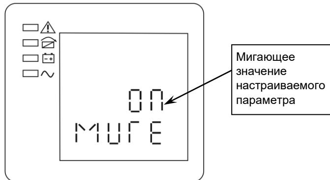
Последовательными нажатиями на кнопку ⚡ (метод перебора) осуществляется выбор одного из двух значений: ON (звуковой сигнал включен) и OFF (звуковой сигнал выключен).
