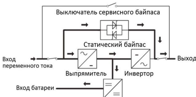
Если напряжение питающей сети выходит за пределы указанного в п. 5 таблицы 1 диапазона, изделие переключается в режим питания нагрузки от АКБ. На ЖК-дисплее отображается соответствующая информация.
