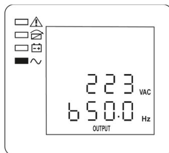
Рисунок 12 — ЖК-дисплей: фаза В, выходное напряжение и частота
