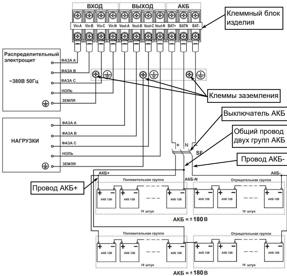
Рисунок 23.4 — Схема подключения изделия и монтажа внешних аккумуляторных батарей для SKAT-UPS 40-3/3-ОН-2х(30x9)
