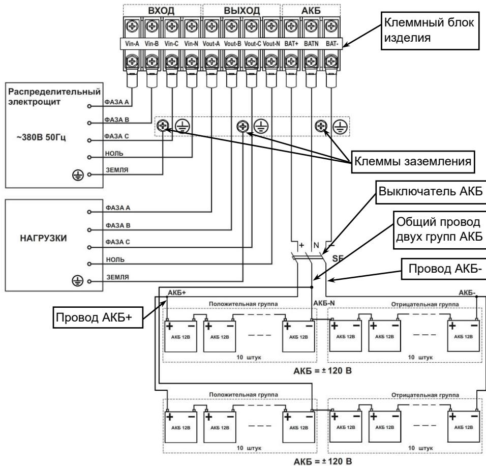
Рисунок 23.2 — Схема подключения изделия и монтажа внешних аккумуляторных батарей для SKAT-UPS 10-3/3-ON-2x(20x9), SKAT-UPS 15-3/3-ON-2x(20x9), SKAT-UPS 20-3/3-ON-2x(20x9)
