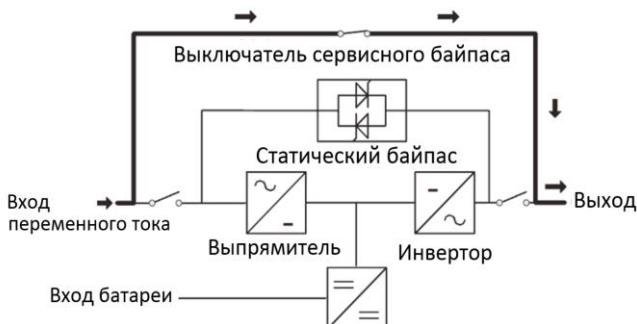
При переключении на сервисный байпас питание нагрузки не прерывается, однако изделие в режиме сервисного байпасса нагрузку от сбоев внешнего электропитания не защищает.
