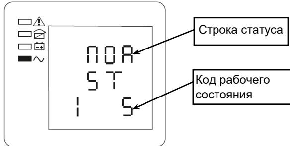
Рисунок 4 — ЖК-дисплей: рабочее состояние и режим.
