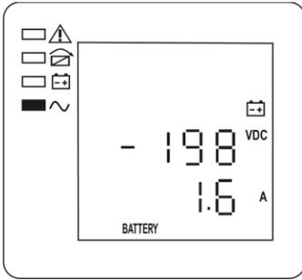
Рисунок 9 — ЖК-дисплей: отрицательная группа АКБ, напряжение и ток
