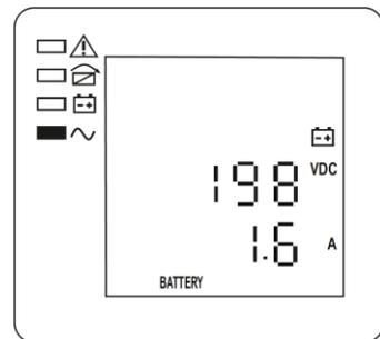
Рисунок 8 — ЖК-дисплей: положительная группа АКБ, напряжение и ток
