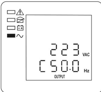
Рисунок 13 — ЖК-дисплей: фаза С, выходное напряжение и частота
