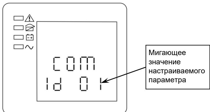
Последовательными нажатиями на кнопку ⌂ (метод перебора) осуществляется выбор одного из диапазона значений: 1 - 15. Если переключатель датчика температурной компенсации включен, следует выбирать адрес из диапазонов: 1 - 10 и 13 - 15.
