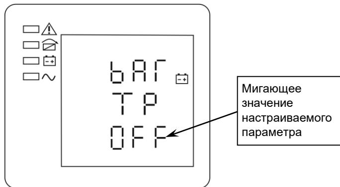
Последовательными нажатиями на кнопку (метод перебора) осуществляется выбор одного из двух значений: ON (датчик включен) и OFF (датчик выключен). Нажатие на кнопку ON, подтвердит выбранное значение, сохранит настройку и осуществит переход к настройке идентификационного адреса. Нажатием на кнопку OFF осуществляется переход к настройке выключателя периодической самопроверки АКБ.
