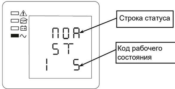
Рисунок 4 — ЖК-дисплей: рабочее состояние и режим.
