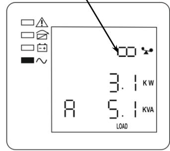
Рисунок 14 — ЖК-дисплей: фаза А, мощность нагрузки
