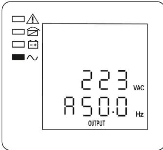
Рисунок 11 — ЖК-дисплей: фаза А, выходное напряжение и частота
