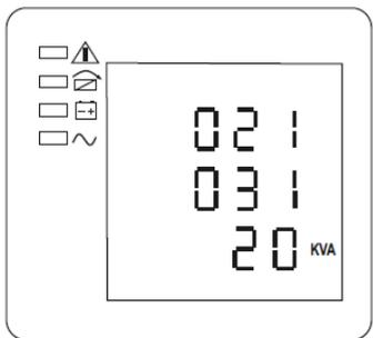
Рисунок 19 — ЖК-дисплей: версия программного обеспечения и модель
