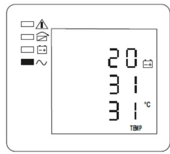
Рисунок 18 — ЖК-дисплей: температура
