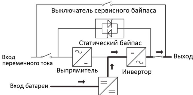
Работа в режиме «РЕЗЕРВ» может продолжаться длительное время, конкретная продолжительность работы зависит от емкости АКБ и величины нагрузки.
