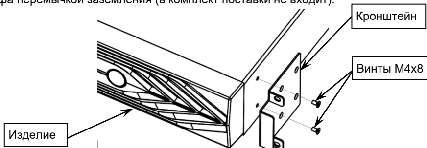
Рисунок 4 — Установка кронштейнов на корпус изделия.
