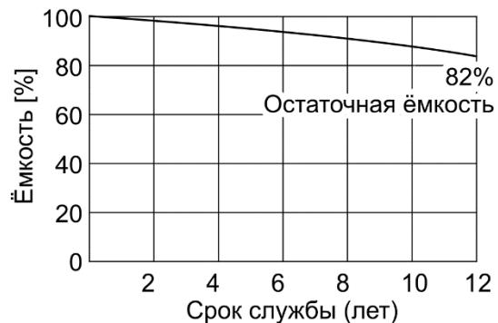
Коэффициент старения аккумуляторных батарей рассчитывается по формуле:
