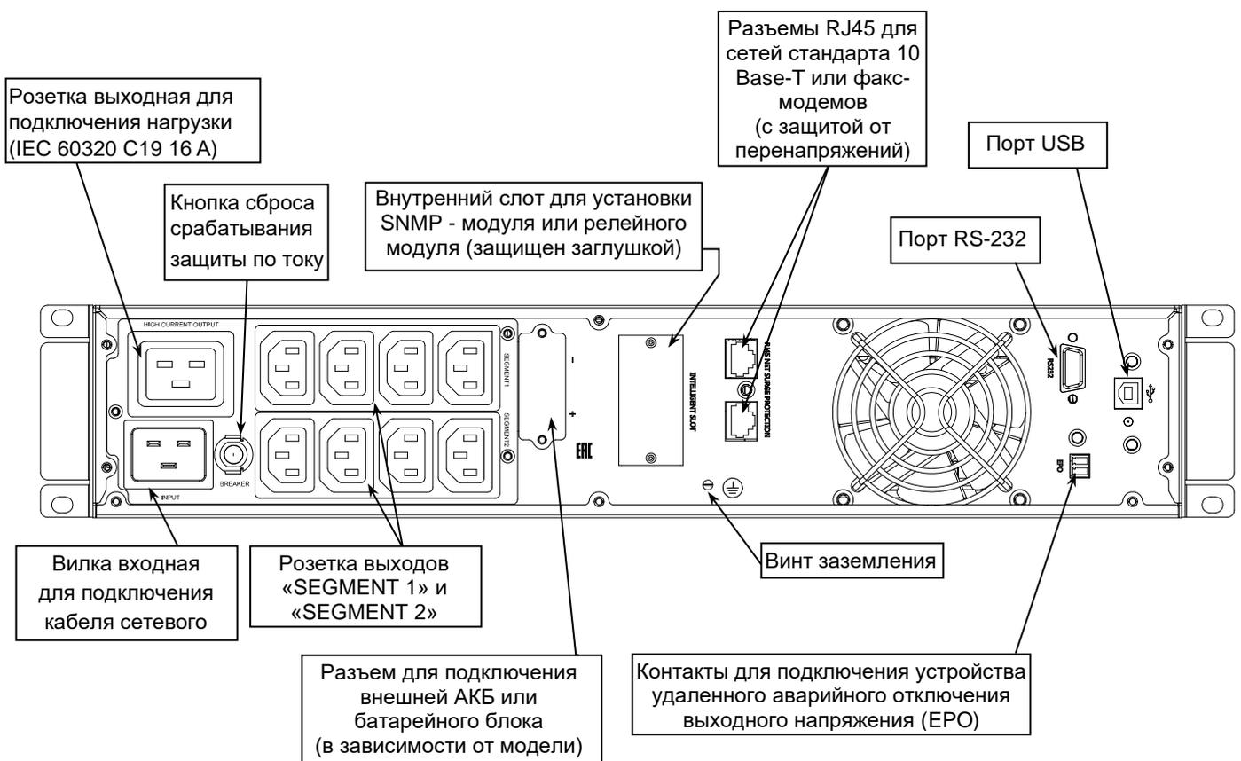
Рисунок 7 – Общий вид задней панели SKAT-UPS 3000-RACK-ON-6x9-E P3, SKAT-UPS 3000-RACK-ON-E P3
