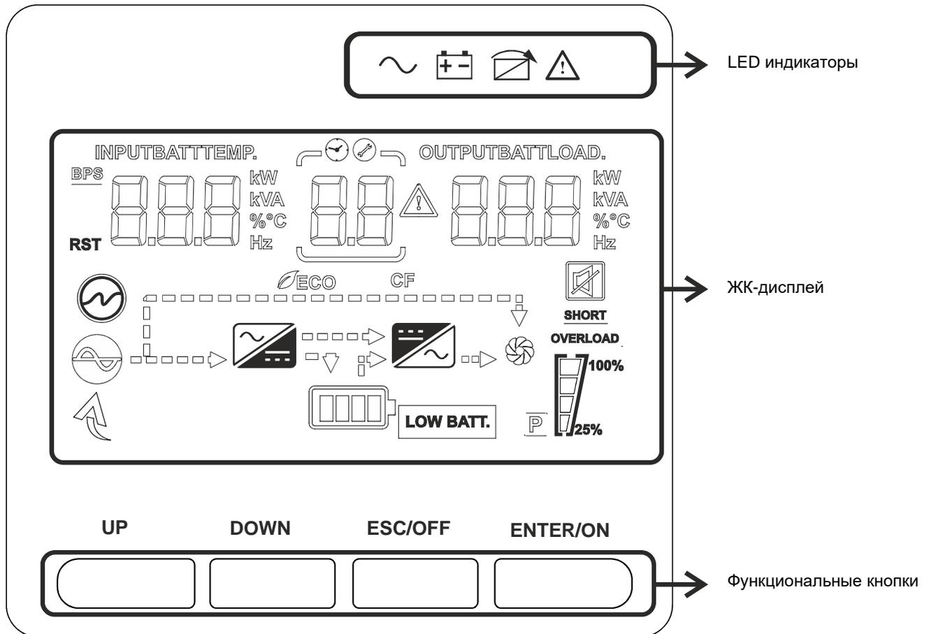
Рисунок 8 – Общий вид органов управления и индикации
