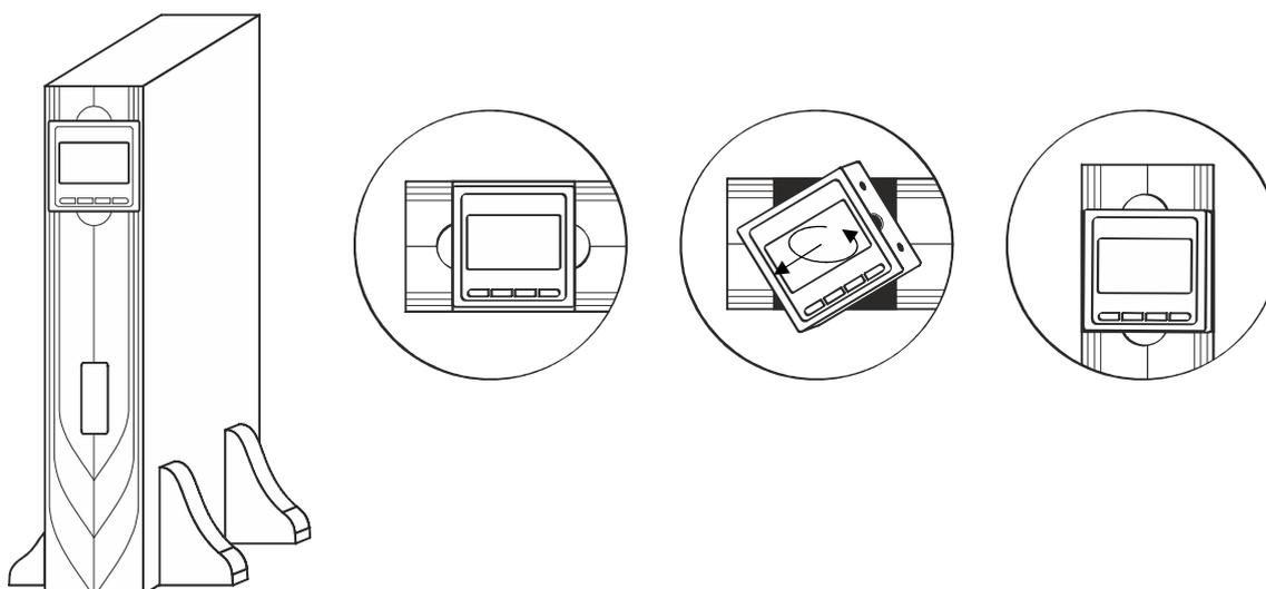
Рисунок 11 – Поворот ЖК-дисплея при напольной установке
