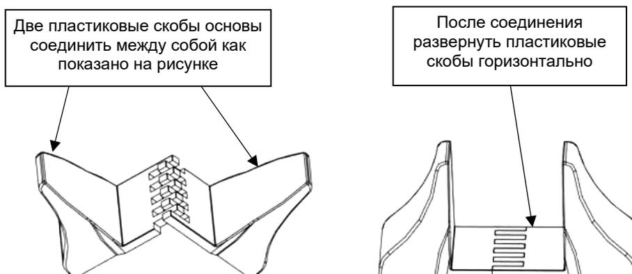
Рисунок 10 – Сборка основы из пластиковых подставок
