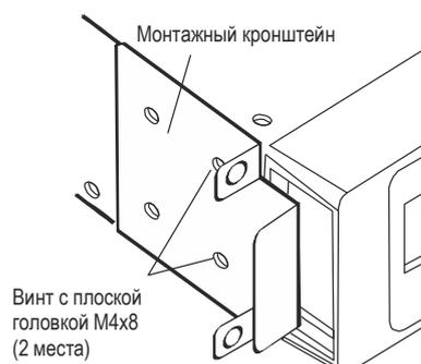
Рисунок 9 – Установка монтажных кронштейнов
