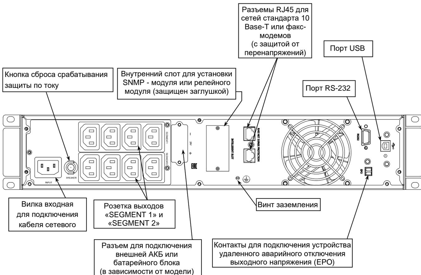
Рисунок 3 – Общий вид задней панели SKAT-UPS 1000-RACK-ON-2x9-E P3, SKAT-UPS 1000-RACK-ON-E P3, SKAT-UPS 1500-RACK-ON-3x9-E P3, SKAT-UPS 1500-RACK-ON-E P3
