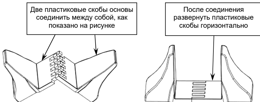
Рисунок 3 – Сборка пластиковых основ для вертикальной установки изделия
