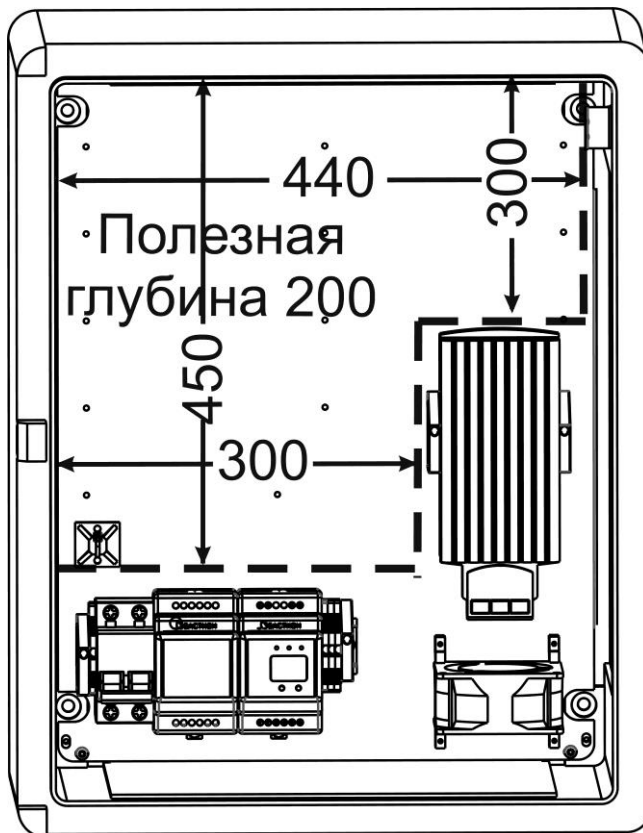
Рисунок 1 – Пространство внутри для установки доп. оборудования
