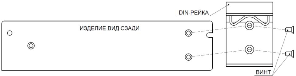
Рисунок 2 – Крепление DIN-рейки.
