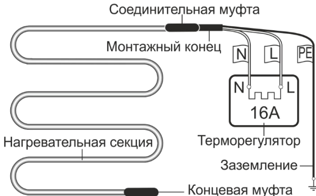
Рисунок 6 - Подключение теплого пола к терморегулятору.
