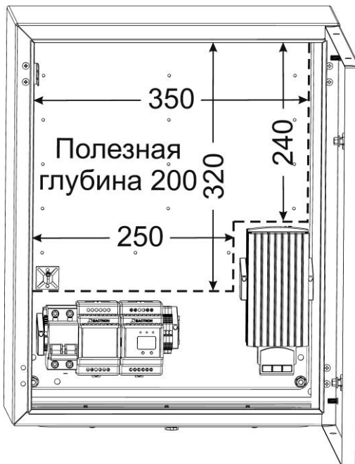
Рисунок 1 – Пространство внутри для установки доп. оборудования
