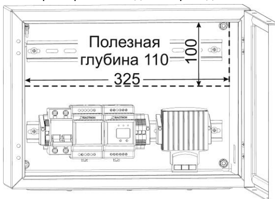
Рисунок 1 – Пространство внутри для установки доп. оборудования
