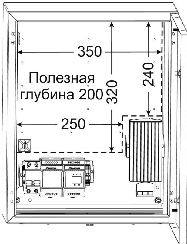
Рисунок 1 – Пространство внутри для установки доп. оборудования
