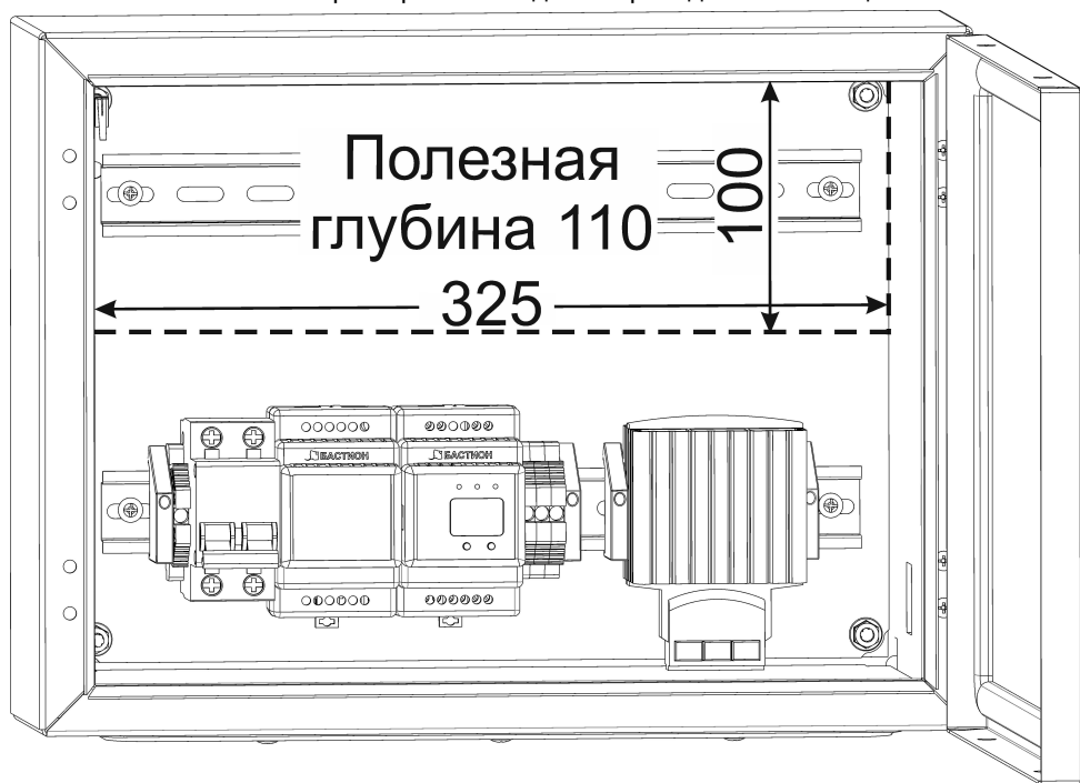
Рисунок 1 – Пространство внутри для установки доп. Оборудования
