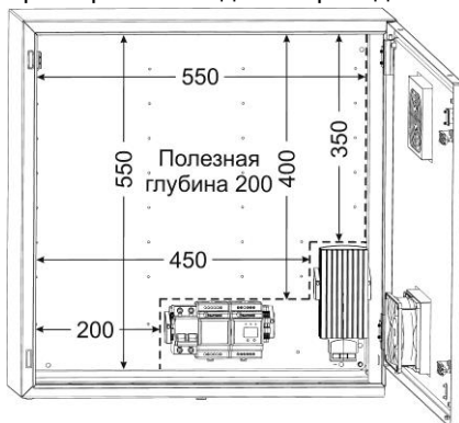
Рисунок 1 – Пространство внутри для установки доп. оборудования
