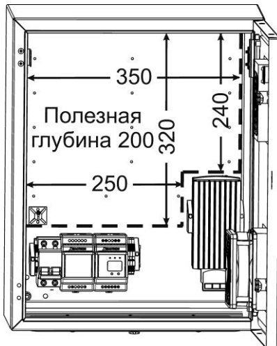
Рисунок 1 – Пространство внутри для установки доп. оборудования
