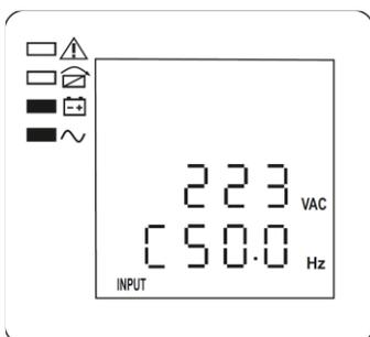
Рисунок 7 – ЖК-дисплей: фаза С, входное напряжение и частота
