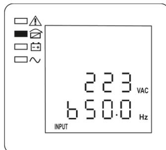
Рисунок 6 – ЖК-дисплей: фаза В, входное напряжение и частота
