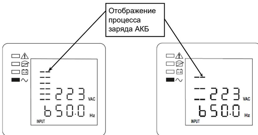
Рисунок 21 – ЖК-дисплей: форсированный (ускоренный) заряд АКБ
