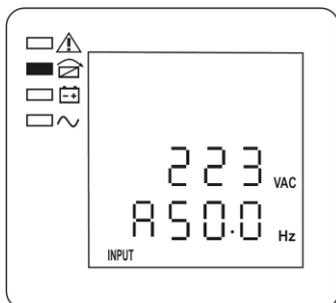
Рисунок 5 – ЖК-дисплей: фаза А, входное напряжение и частота
