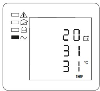
Рисунок 18 – ЖК-дисплей: температура АКБ, внутренняя и внешняя температура
