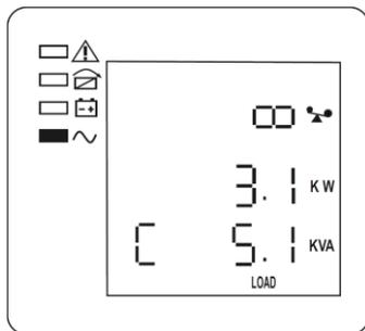
Рисунок 16 – ЖК-дисплей: фаза С, мощность нагрузки
