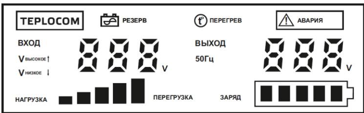
Рисунок 4 — Светодиодный графический индикатор.
