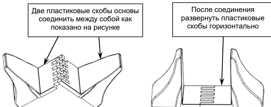
Рисунок 3 - Сборка пластиковых основ для вертикальной установки изделия.
