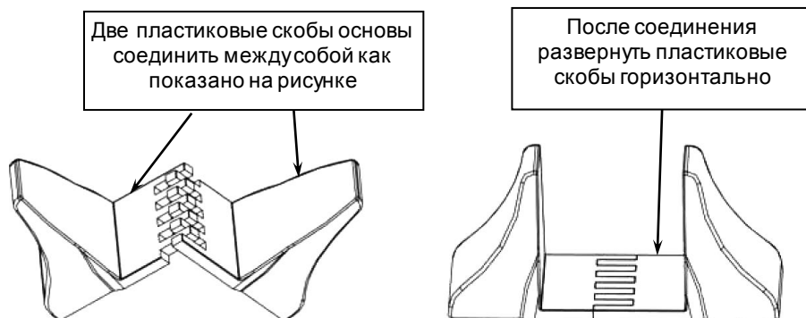
Рисунок 3 - Сборка пластиковых основ для вертикальной установки изделия.
