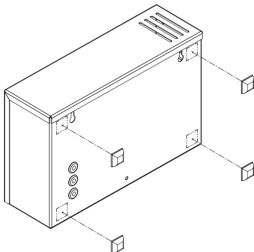
2) Закрепите источник на вертикальной поверхности используя штатные отверстия, предварительно протянув провода во вводные отверстия:
