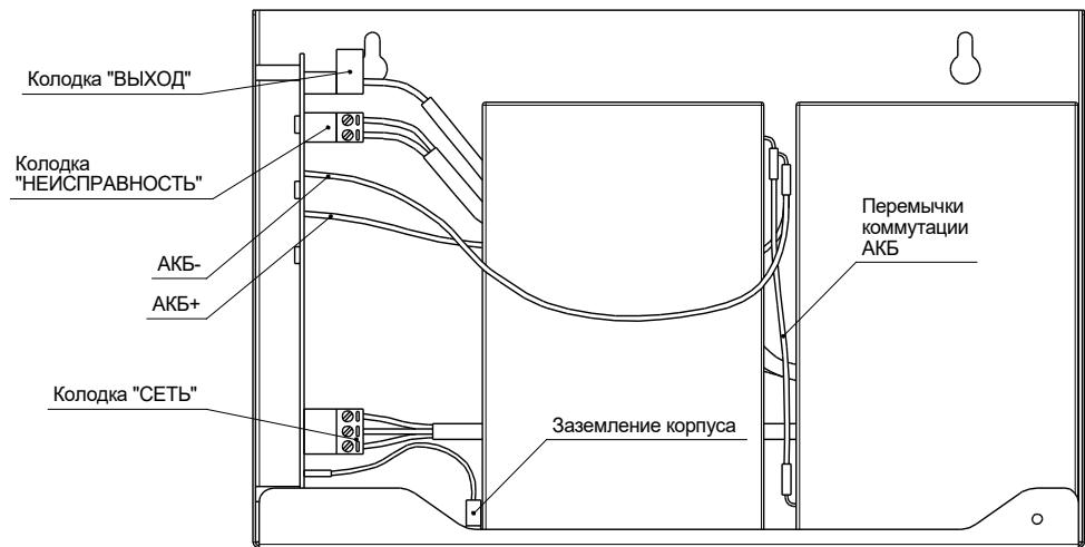
Рекомендуемая схема монтажа для одной АКБ 17 Ач:
