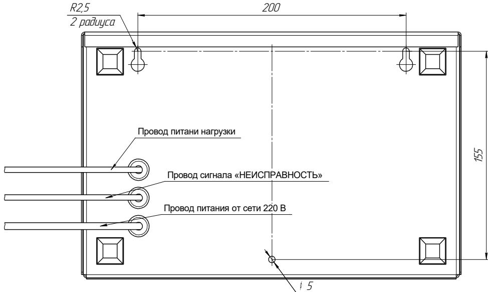
3) Открутите винт-саморез и снимите крышку с источника. Осуществите установку АКБ и коммутацию проводов внутри корпуса.
