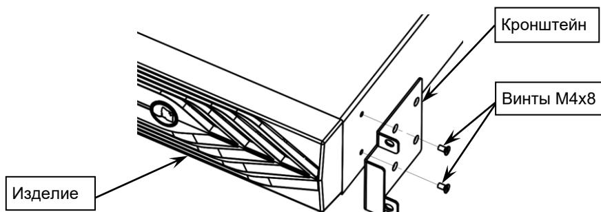
Рисунок 4 — Установка кронштейнов на корпус изделия.
