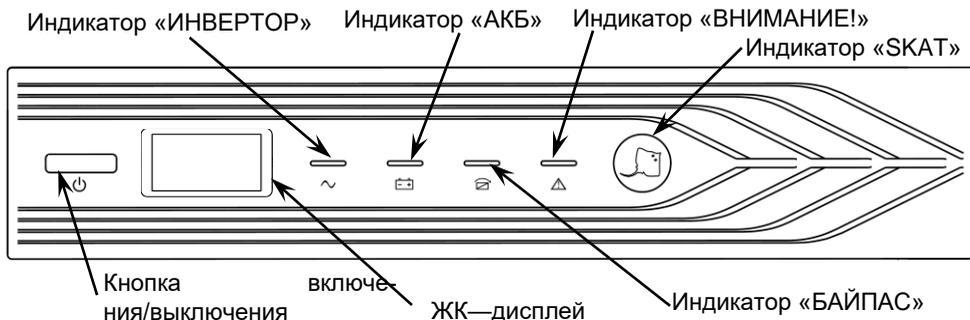
Рисунок 1 – Общий вид передней панели изделия.
