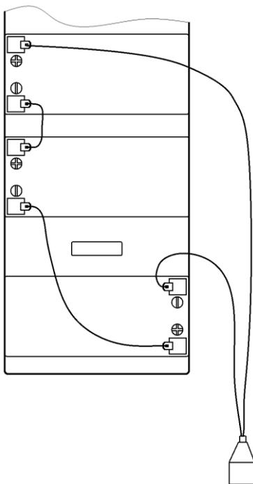
Рисунок 6 — размещение АКБ в лотке
