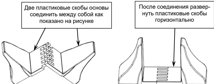
Рисунок 3 - Сборка пластиковых основ для вертикальной установки изделия.
