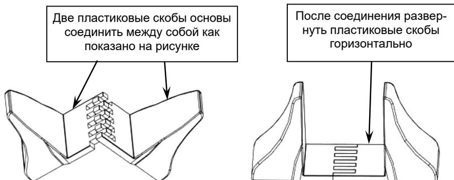
Рисунок 3 - Сборка пластиковых основ для вертикальной установки изделия.
