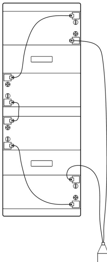
Рисунок 6 — размещение АКБ в лотке
