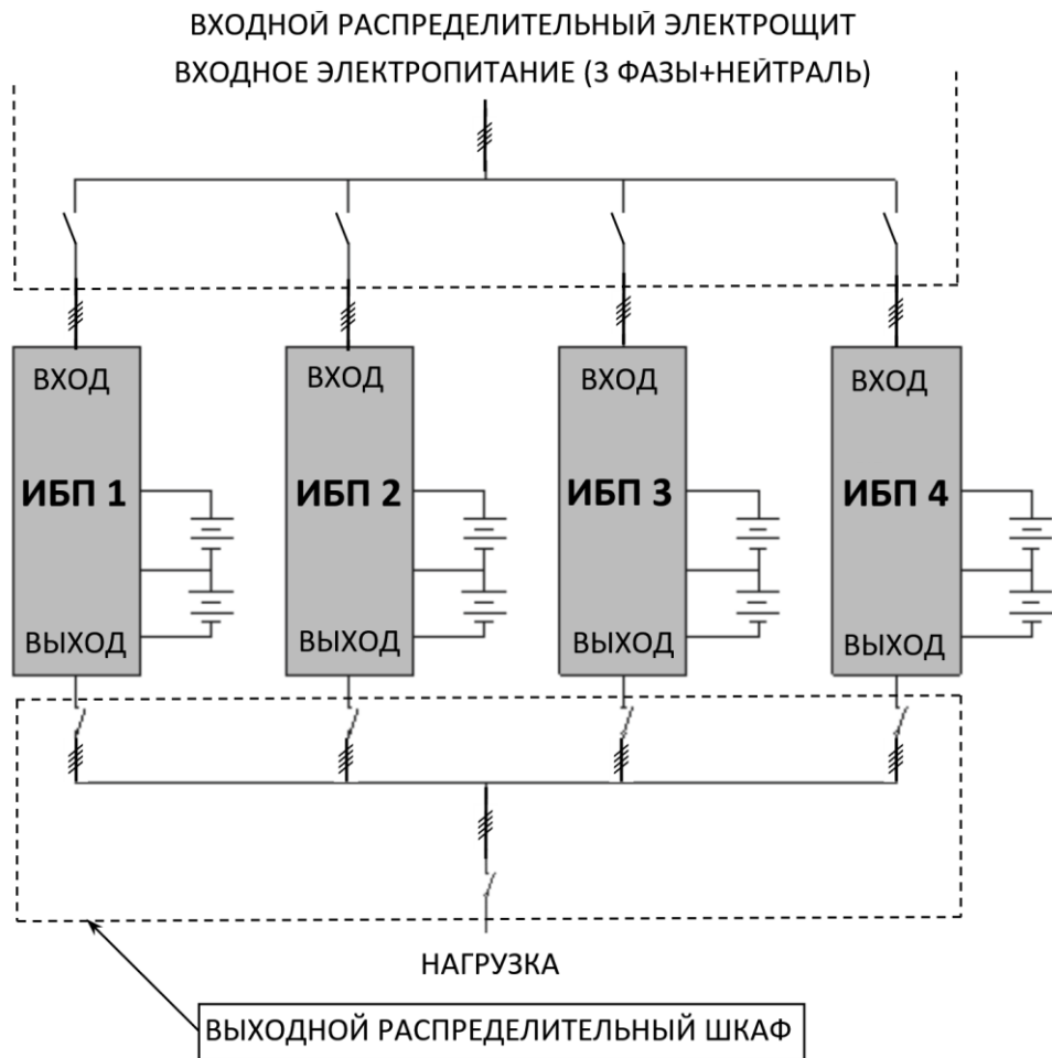
Рисунок 24 – Пример схемы подключения четырех изделий в систему параллельного резервирования с выходным распределительным шкафом.
