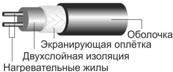
Рисунок 3 – Устройство нагревательного кабеля.
