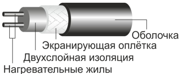
Рисунок 3 - Устройство нагревательного провода.
