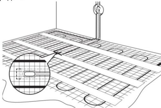
8. Вывести монтажный конец нагревательного мата к месту расположения терморегулятора через канавки, подготовленные в стене. Визуально проверить отсутствие обрывов (с помощью омметра замерить сопротивление нагревательной секции и с помощью мегаомметра измерить сопротивление изоляции нагревательной секции).
