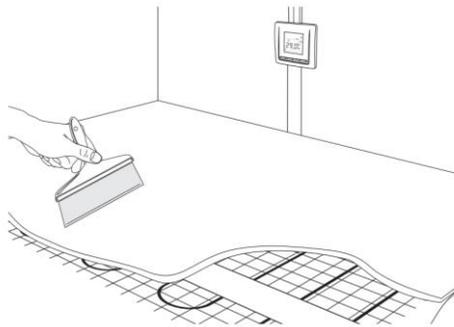
10. После полного высыхания плиточного клея еще раз с помощью омметра замерить сопротивление нагревательных матов и с помощью мегаомметра измерить сопротивление изоляции нагревательных матов.
