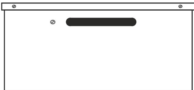
**Аккумуляторный отсек УМБ-3/120** (далее по тексту – отсек) предназначен для установки в нем герметичных необслуживаемых свинцово-кислотных аккумуляторов, соответствующих стандарту CEI IEC 1056-1 (МЭК 1056-1). Вместимость отсека представлена в табл.1. В отсеке могут быть установлены аккумуляторы других типов и емкости, соответствующие по размеру данному отсеку.
