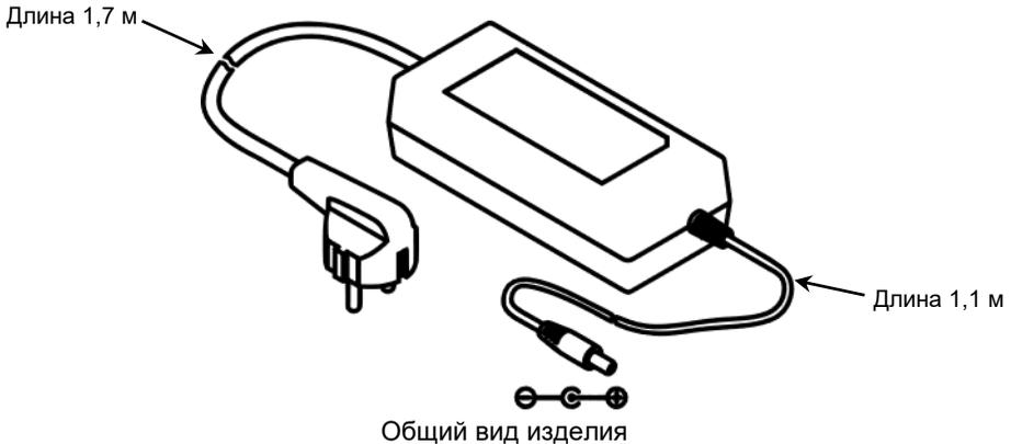
Изделие имеет вилку для подключения к сети ~ 220 В 50 Гц и выходной разъем DC 2.5x5.5x10 для подключения нагрузки. При включении вилки в сеть, на выходной разъем подаётся напряжение 52 В постоянного тока.
