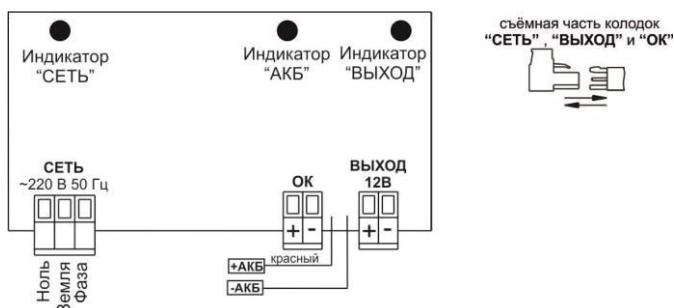
Рисунок 1 - вид изделия с открытой крышкой (схема подключения)
