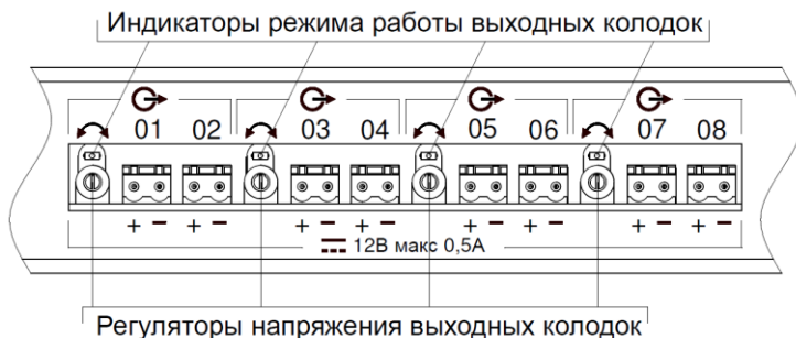
Рисунок 2 – Увеличенное изображение выходных колодок ПН
