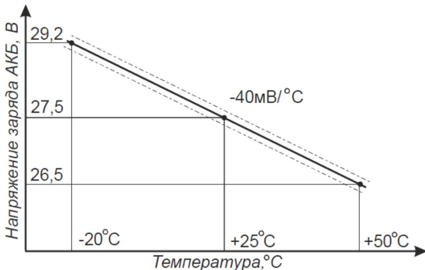
Рисунок 2 – Зависимость напряжения заряда АКБ от температуры
