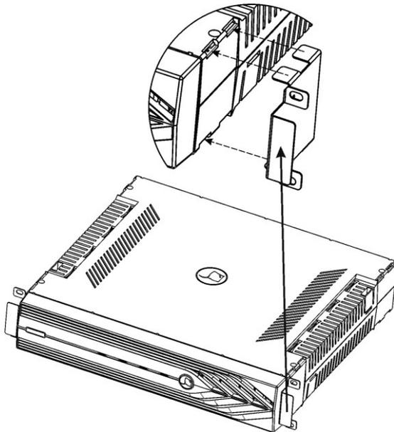
Рисунок 3 – Крепление кронштейнов для установки изделия в стойку 19"
