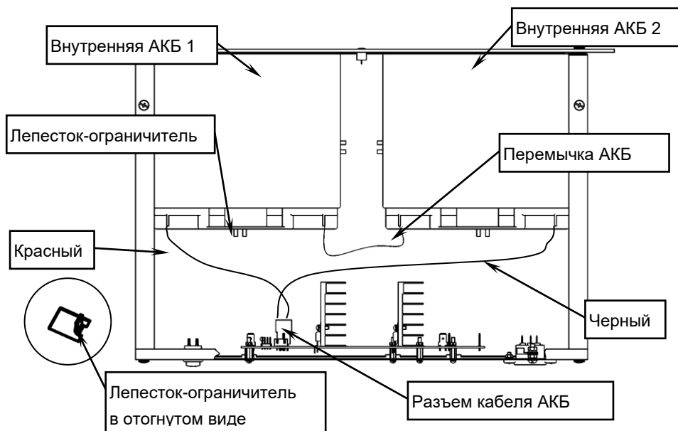
Рисунок 4 – вид изделия со снятой крышкой и установленными АКБ
